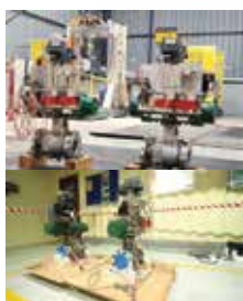
ШАРОВЫЕ КРАНЫ С ОПОРОЙ Класс давления: от 150# до 2500# Типоразмер: от 2" до 48"
